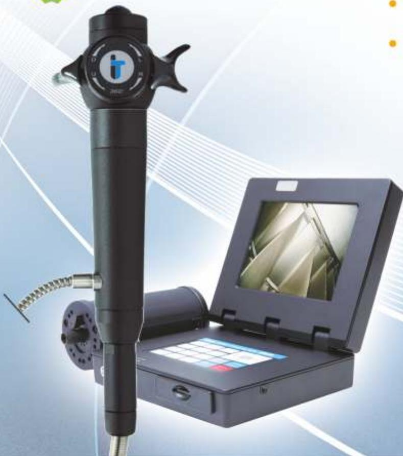
Эргономичная рукоятка обеспечивает работу одной рукой с помощью уникальной тормозной системы и кнопки захвата изображения
